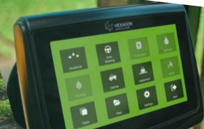
**HxGN AgrOn ISOBUS Display** promuove un protocollo standard aperto per interconnettere sistemi elettronici integrati attraverso una connessione digitale, consentendo la comunicazione dei dati tra sensori, attuatori e controllori. Il sistema consente la compatibilità della comunicazione tra l'attrezzo agricolo e lo schermo Ti7, generando un maggiore controllo delle attività e un funzionamento più semplice.
